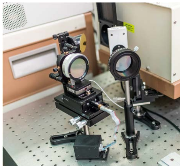
■ Obr. 12 Detail uspořádání laditelného optického retardéru sloužícího pro konverzi lineární polarizace laserového paprsku na kruhovou, podrobnosti viz [29].
