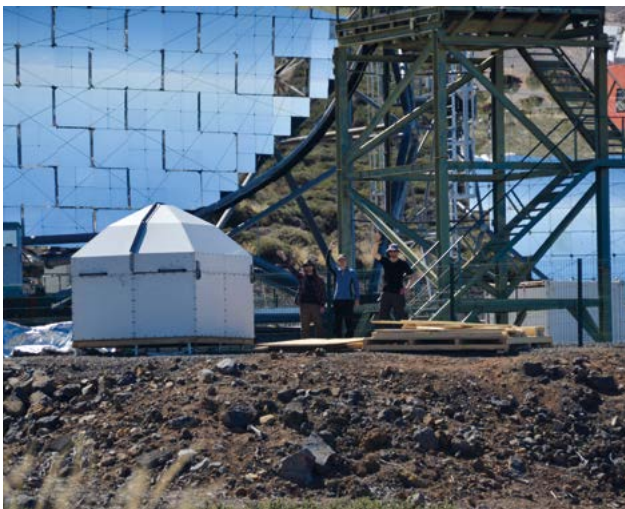
■ Obr. 2 Kopule dalekohledu FRAM, který byl v říjnu minulého roku postaven na observatoři Observatorio del Roque de los Muchachos na ostrově La Palma. Dalekohled bude sloužit k monitorování aerosolové optické tloušťky atmosféry, což má zásadní význam pro kalibraci dat budované observatoře Cherenkov Telescope Array. V pozadí jsou zrcadla čerenkovských teleskopů MAGIC a po pravé straně kopule stojí náš instalační tým.
