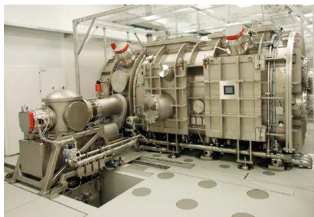
■ Obr. 5 Vakuový mřížkový kompresor výstupních laserových pulsů systému L3-HAPLS. Výstupní pulsy generované laserovým řetězcem (45 J) jsou komprimovány na délku <30 fs pomocí difrakčních mřížek o rozměrech 80×36 cm. Vzhledem k velmi vysoké špičkové intenzitě pulsů musí být optická soustava kompresoru umístěna ve vakuu – vakuová komora má rozměry 5,1 × 2,7 × 2,2 m.
