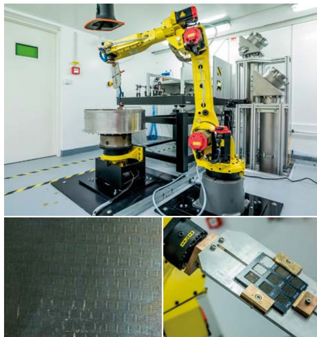
■ Obr. 15 Nahoře – uspořádání pracoviště LSP s robotickým ramenem pro manipulaci se vzorky, optickým stolem pro práci se svazkem a laserovým distribučním systémem. Vlevo dole – typická textura po zpracování technologií LSP. Vpravo dole – povrchy vzorků modifikované pomocí různých parametrů technologie laser shock peening.
