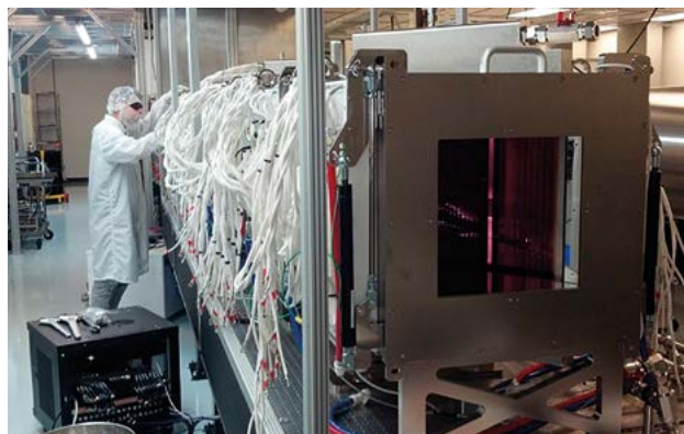
■ Obr. 8 Výstupní kJ zesilovač systému L4: aktivním prostředím je Nd:dopované sklo a velikost optické apertury je 30 × 30 cm.
