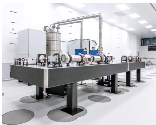
Obr. 3 První část laseru L2, 10J/10Hz laserový řetězec s Yb:YAG kryogenním stupněm, instalovaný v centru ELI Beamlines.
