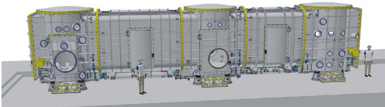
■ Obr. 9 10 PW vakuový optický kompresor systému L4 má délku 18 m a výšku 4,2 m. Komora kompresoru je nyní ve výrobě a bude instalován v ELI Beamlines v druhé polovině roku 2019.
