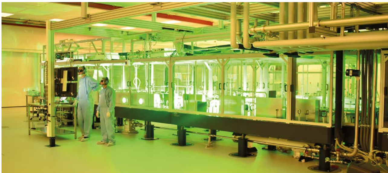
■ Obr. 4 Laserový systém L3-HAPLS během ověřovacích zkoušek v centru ELI Beamlines. Výstupní pulsy na vlnové délce ~810 nm jsou generovány v Ti:safírovém výkonovém zesilovači buzeným laserovým svazkem na vlnové délce 527 nm. Na snímku je vidět zbytkové rozptýlené zelené světlo tohoto svazku, který je vytvářen jako druhá harmonická frekvence z primárního svazku na vlnové délce 1053 nm.
