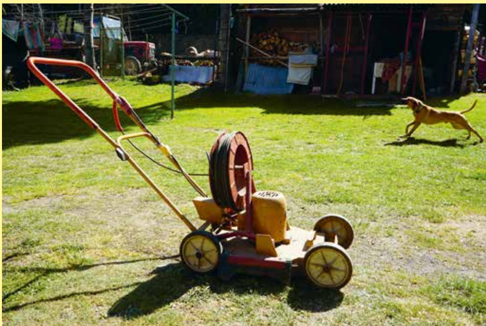
Sekačka s motorem z pračky vyrobená podle návodu z časopisu Udělej – Urob si sám (foto: autorský tým)
