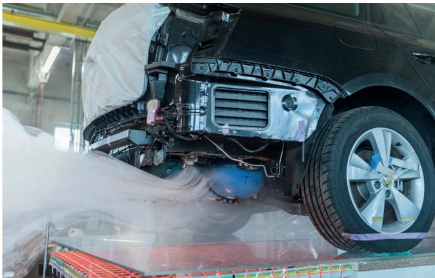
Jeden z pokusů v Ústavu pro hydrodynamiku AV ČR. Plyn, který je vidět na snímku, neuniká z auta dozadu, ale naopak je nasáván pod automobil (na fotografii tedy teče zleva doprava).
