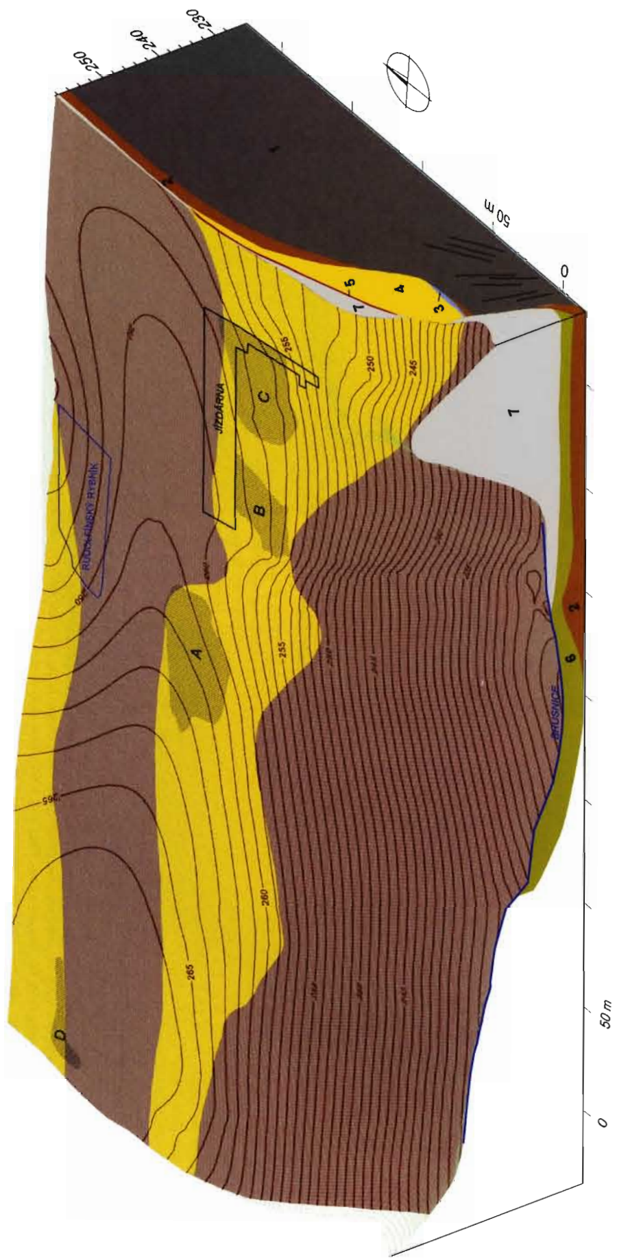
Obr. 6: Rekonstruovaný model povrchu „podloží“. Orthografický pohled od JV. Souřadnicový systém JTSK, Křovákovo zobrazení, výškový systém Balt p.v. Zelená síť promítá současný povrch. Na profilch bloku : 1 – letenské souvrství (ordovik, zvětralé a pevné horniny); 2 – zvětraliny souvrství (hlinitokamenitá eluvia a deluvia); 3 – terasové uložení Brusnice; 4 – spraše a sprašové hlíny (pleistocén, rekonstrukce); 5 – humózní hlíny/půdní horizont; 6 – náplavy Brusnice promísené antropogenními navážkami; 7 – antropogenní navážky. Pohřebiště: A – Jizdárna - skupina západ (Smetánka 1994, Fig. 3:A), B – Jizdárna - skupina střed (Borkovský 1951; 1952), C – Jizdárna - skupina východ (Borkovský 1951; 1952; Frolík - Tomková - Žegklitz 1988), D – Jelení-Lumbeho zahrada (Březinová - Turek 1999).
