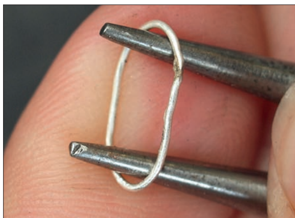
Obr. 6/402: Kroužek je zploštěn pomocí kleští nebo pouze rukou do oválného tvaru.
