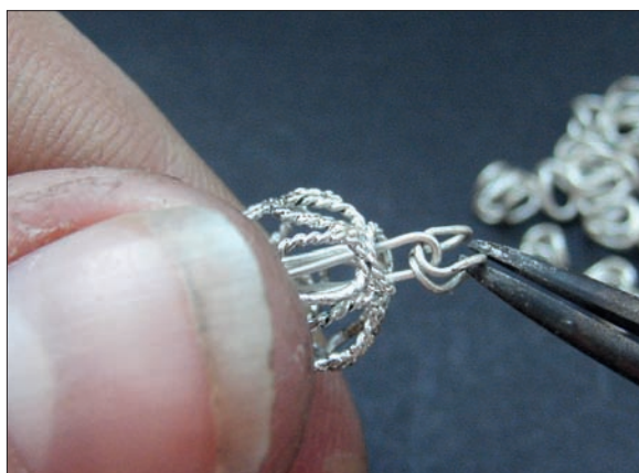
Obr. 6/414: Detail pletení řetízku z místa za perlou, další článek je provléknut oválným kroužkem. Fig. 6/414: Weaving of the chain behind the bead, in detail. The other link is threaded through a small oval ring.
