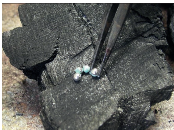
Obr. 6/260: Granule jsou vyskládány do kroužků a přidána difuzní pájka.
