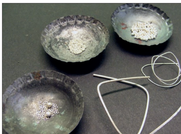
Obr. 6/280: Dráty, kroužky a granule potřebné na zhotovení náušnice. Foto
