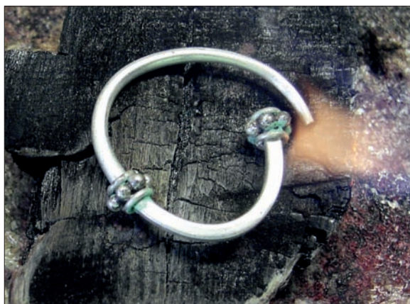
Obr. 6/270: Pájení uzlíků k tělu náušnice.
