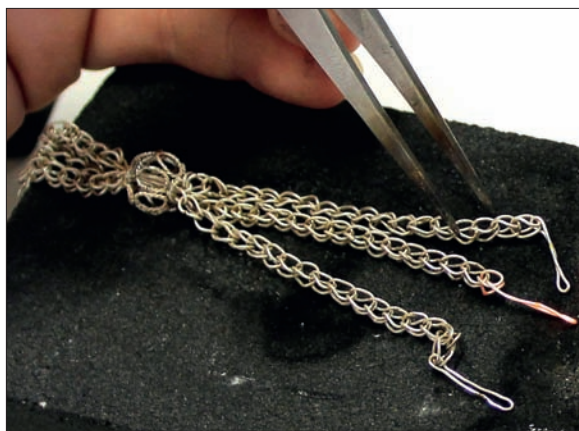
Obr. 6/412: Pájení oválných článků. Foto J. Sobek. Fig. 6/412: Soldering of oval links. Photo: J. Sobek.
