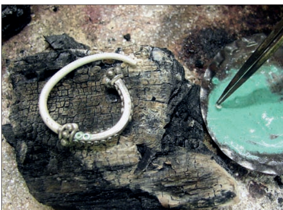
Obr. 6/271: Do prostoru mezi uzlíky jsou kroužky vyskládány vždy jen na jednu stranu, aby při pájení nespadly.
