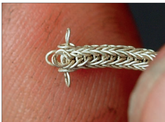
Obr. 6/324: Další kroužek se do řetízků se vplétá stejně jako na obr. 6/320 až 6/322. Následný kroužek je vždy umístěn křížem k předešlému. Fig. 6/324: Another small loop is weaved in the chain in the same way as shown on Figs. 6/320–6/322. Subsequent small loop is always placed crosswise to the last one.
