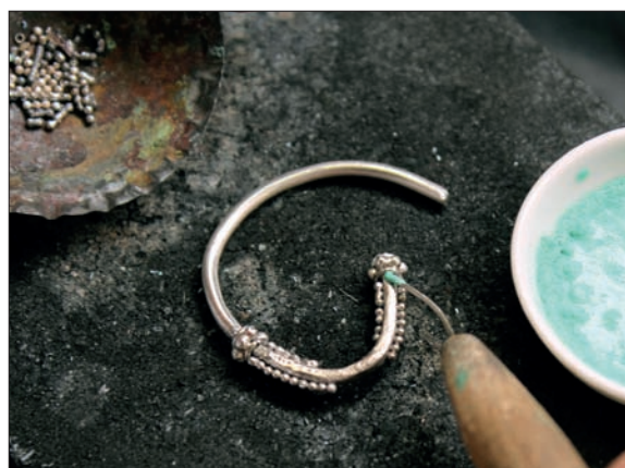
Obr. 6/281: Vyskládání granulí mezi uzlíky náušnice. Foto J. Sobek.
