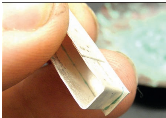
Obr. 6/336: Po té se na vrchní část víčka přiloží plech, který je fixován drátem nebo plechovou svorkou.
