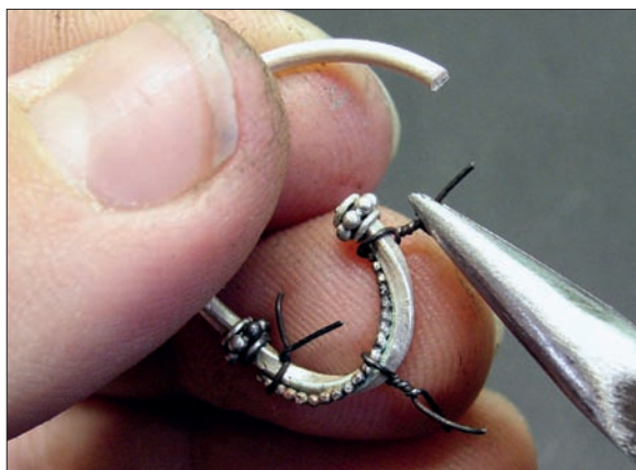
Obr. 6/304: Perlovec byl připevněn pomocí svorky z drátu; drátek se pájel po jednom vzhledem ke složitosti tordování.
