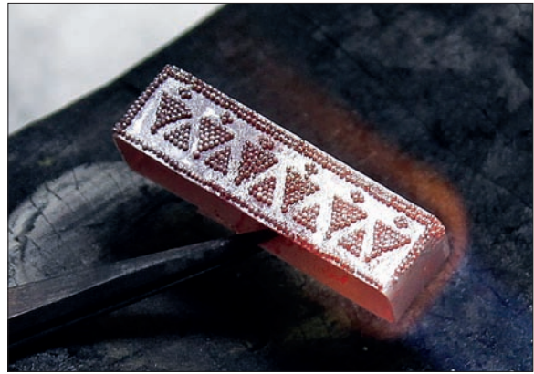
Obr. 6/343: Pájení granulace na víčku kaptorgy. Foto J. Sobek.
