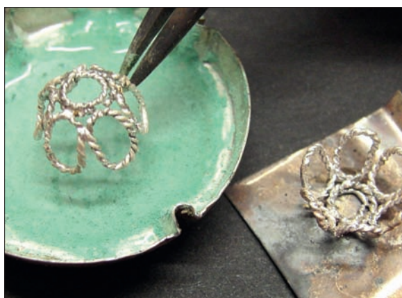
Obr. 6/396: Nanesení difúzní pájky v místě pájeného spoje.
