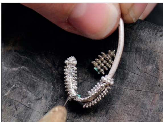
Obr. 6/287: Seskládání hrozníčků a těla náušnice s difuzní pájkou do prostoru spoje. Foto J. Sobek. Fig. 6/287: Positioning of the grapes on the lower arch with the help of powder of malachite mixed with gum tragacanth. Photo: J. Sobek.
