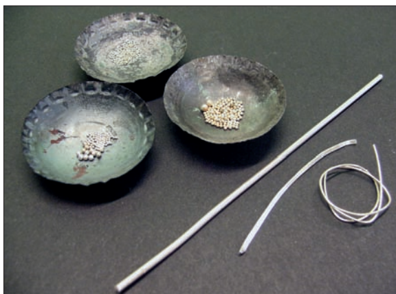
Obr. 6/291: Pohled na polotovary potřebné ke kompletaci šperku; dráty, granule a kroužky.
