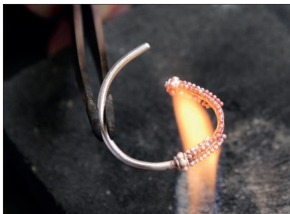
Obr. 6/282: Pájení granulí na náušnici. Foto J. Sobek. Fig. 6/282: Soldering of granule on the central wire of earring. Photo: J. Sobek.
