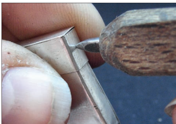
Obr. 6/340: Vytvoření otvoru po obou stranách kaptorgy jehlou.
