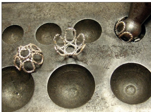
Obr. 6/394: Tvarování poloviny perly za pomoci čakanu. Profilování čakanem se dělalo pouze ručně, aby se nepoškodil filigránový drát.
