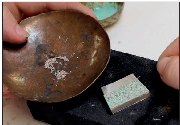
Obr. 6/345: Vyskládání granulí na celou přední část kaptorgy. Foto J. Sobek.
