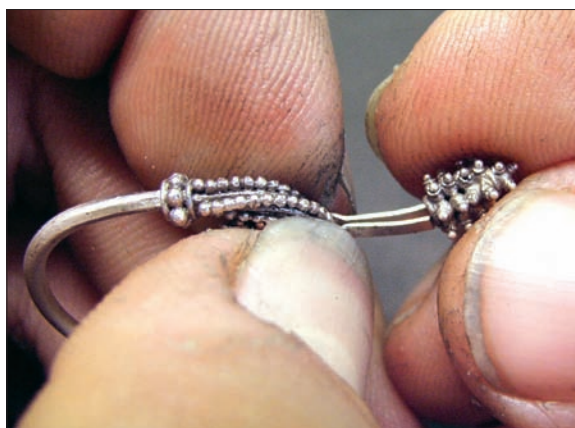
Obr. 6/309: Druhá část hrozníčku je navléknuta na pásek a do míst pájení je nanášena difuzní pájka.
