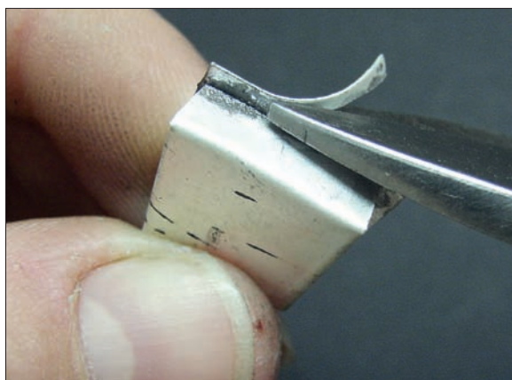
Obr. 6/359: Přebytečný plech je odštířen.
