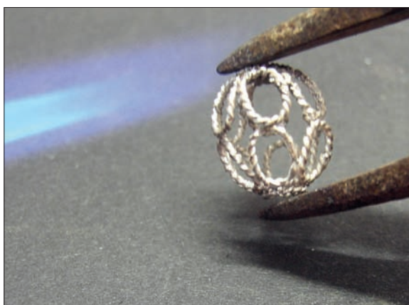
Obr. 6/397: Pájení perly uchycené v pinzetě. Pájet je možné také na kovové podložce.
