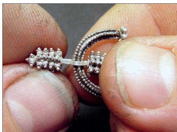
Obr. 6/296: V místě pájeného spoje je opět nanesena difuzní pájka.
