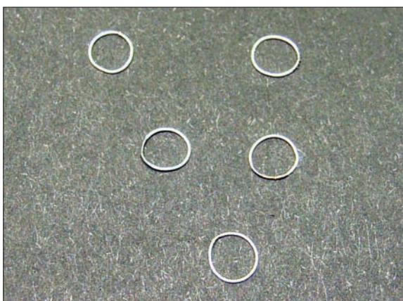
Obr. 6/318: Pohled na spájené kroužky. Fig. 6/318: Soldered small rings.
