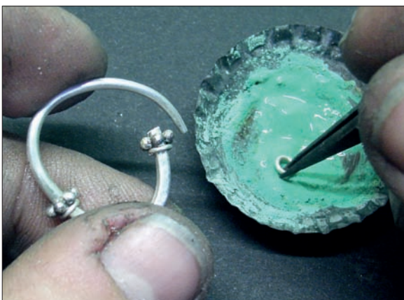
Obr. 6/269: Umístění kroužků a věnečků pomocí difuzní pájky.
