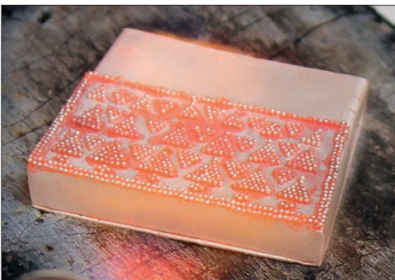
Obr. 6/346: Pájení granulace na tělo kaptorgy. Foto J. Sobek.
