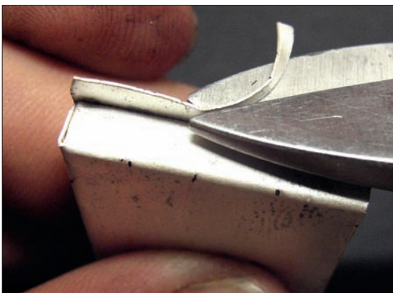
Obr. 6/334: Přebytečný plech je odštížen.
