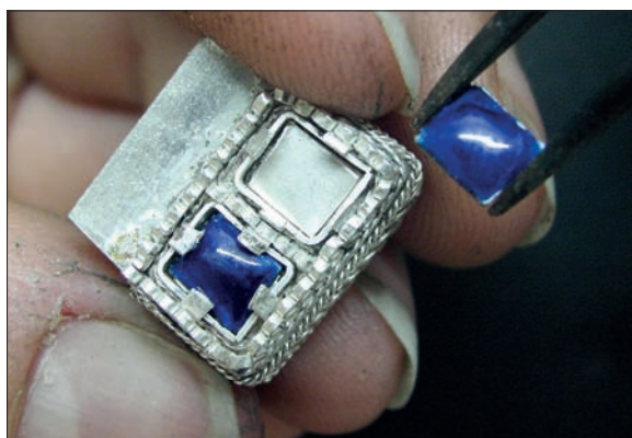
Obr. 6/383: Umísťování skleněné vložky do obruby.
