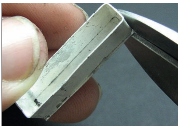
Obr. 6/338: Přebytečný okraj je zastřižen a zabroušen na brousku.
