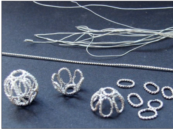
Obr. 6/388: Postupná řada od jednoduchého drátu přes tordovaný, jednotlivé oválné kroužky, připravené polokoule až k hotové perle.
