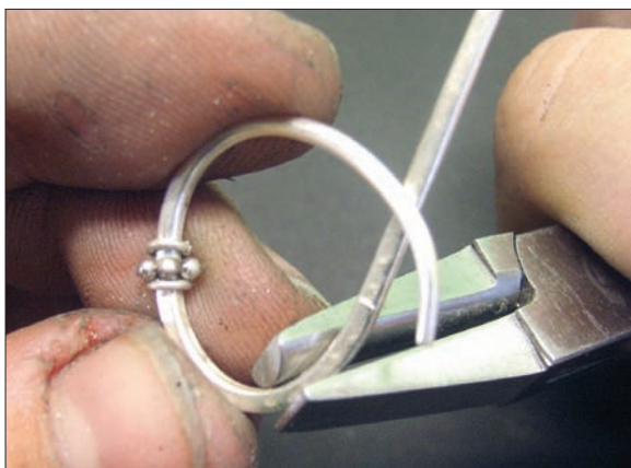
Obr. 6/267: Tvarování těla náušnice kulatými kleštěmi.
