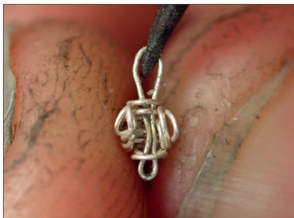
Obr. 6/320: Kroužek je vplétán vždy pod dvě předešlé řady. Fig. 6/320: The small loop is always weaved beneath the two last rows.
