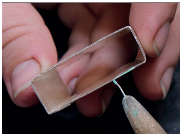
Obr. 6/428: Pájení vrchního plechu víčka kaptorgy. Foto J. Sobek. Fig. 6/428: Soldering of upper sheet of the kaptorga 's cover. Photo: J. Sobek.
