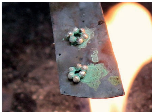
Obr. 6/261: Pájení věnečku z granulí. Fig. 6/261: Soldering of a small ring of granules.
