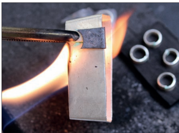
Obr. 6/427: Pájení víčka kaptorgy Foto J. Sobek. Fig. 6/427: Soldering of the kaptorga 's cover. Photo: J. Sobek.
