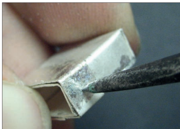
Obr. 6/362: Po pájení pásku je vytvořen otvor pomocí ocelové jehly.
