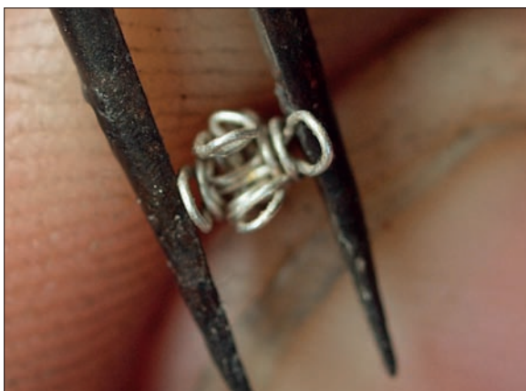
Obr. 6/322: Přihnutí kroužku směrem nahoru. Fig. 6/322: Tilting of the small loop.
