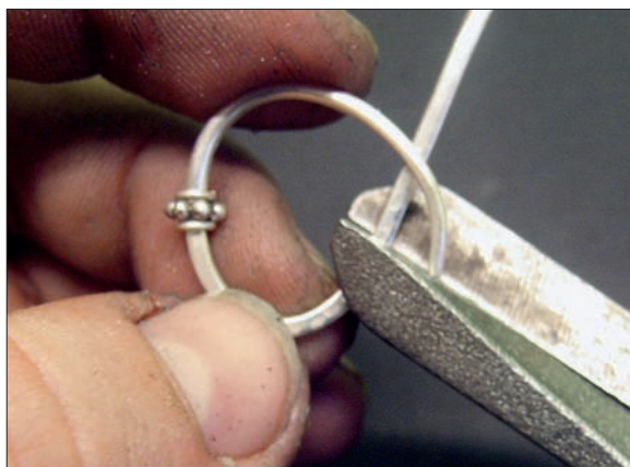
Obr. 6/268: Zkrácení drátu na požadovanou délku.
