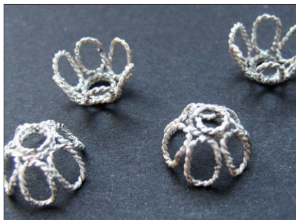
Obr. 6/395: Připravené polokoule s připájeným druhým kroužkem na vršku.
