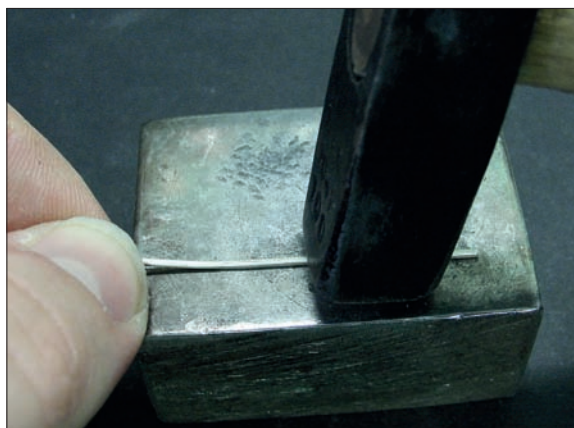
Obr. 6/258: Roztepání kulatého drátu do čtyřhranného profilu v místě,
