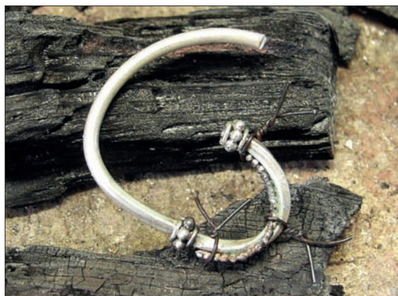
Obr. 6/305: Na místo pájeného spoje byla nanášena difuzní pájka a poté následovalo pájení.
