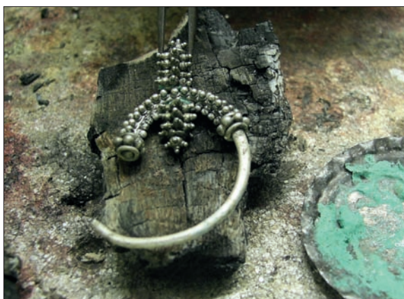
Obr. 6/275: Tělo a hrozníček jsou v místě spoje opatřeny difuzní pájkou.
