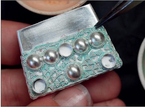
Obr. 6/439: Vyskládání granulí přidáním difuzní pájky.
