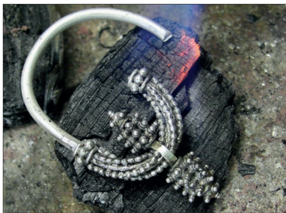
Obr. 310: Následuje závěrečné pájení náušnice, vyčištění a vyleštění.
