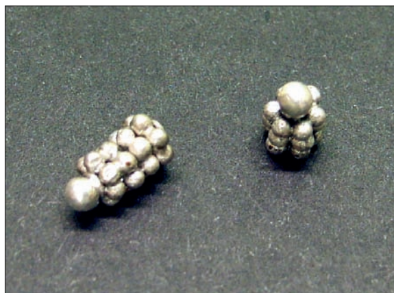
Obr. 6/264: Detail po připájení kroužků a granule pomocí difuzní pájky. Fig. 6/264: Soldering of small rings topped by a big granule.
