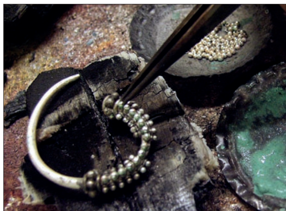
Obr. 6/273: Po připájení kroužků jsou malé granule vyskládány vždy po jedné straně s difuzní pájkou a připájeny.
