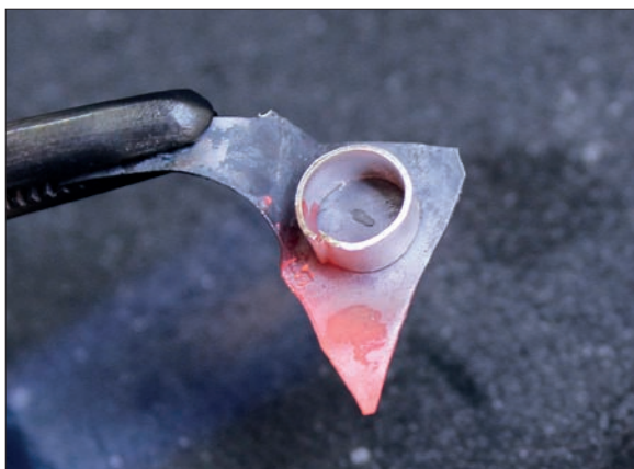
Obr. 6/431: Pájení obruby na plechové podložce. Foto J. Sobek. Fig. 6/431: Soldering of the bezel on a sheet pad. Photo: J. Sobek.
