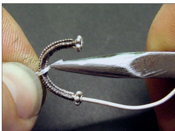
Obr. 6/294: Na spodní, dekorovanou část je umístěn plechový pásek přehnutý na polovinu.
