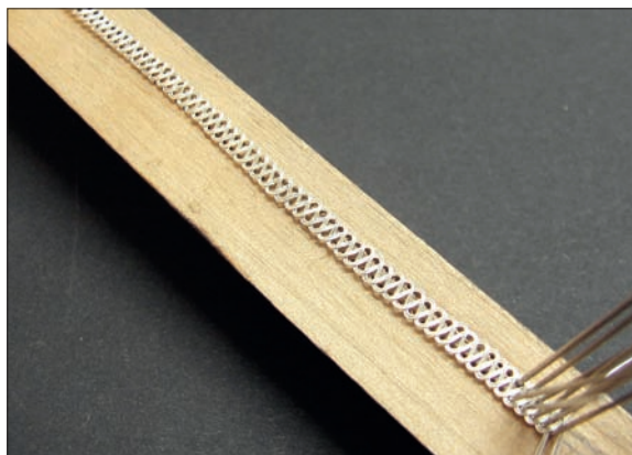
Obr. 6/367: Postupným pletením – přehýbáním pramenů copu kolem jehel je docíleno stejnoměrnosti pletence.
