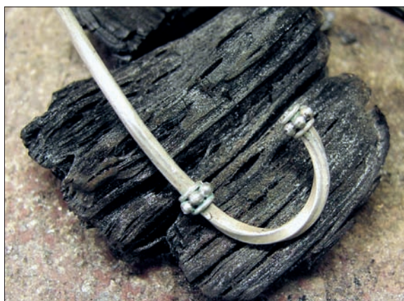
Obr. 6/302: Následuje připájení uzlíků na tělo náušnice.
