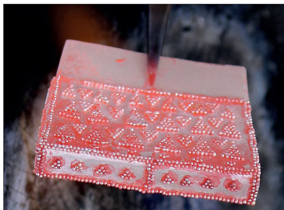
Obr. 6/348: Pájení granulace na spodní straně, opět je nutné dekorovat vždy po jedné straně. Foto J. Sobek.
