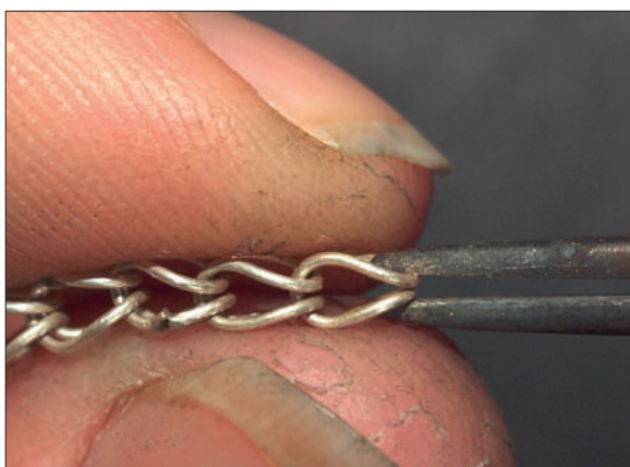
Obr. 6/410: Řetízek je připraven, aby se k němu přidal další segment; postup se opakuje. Fig. 6/410: The chain is ready for attachment of another link; the course of work is repeated.
