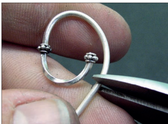
Obr. 6/303: Drát náušnice je zkrácen na požadovanou délku.
