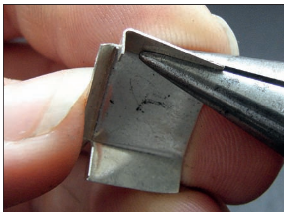
Obr. 6/354: Přehýbání boků kaptorgy pomocí plochých kleští.
