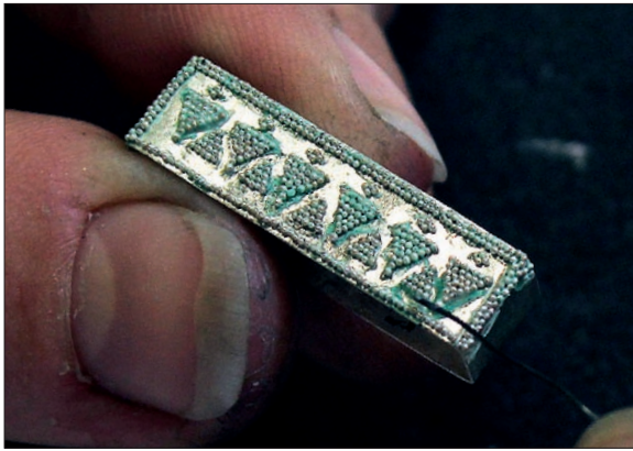
Obr. 6/342: Postup vyskládání granulí je časově náročný, důležitá je pečlivost při výběru granulí podle velikosti a přesné vyskládání ornamentu. Foto J. Sobek.
