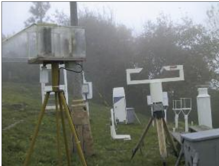
Pohled na „meteorologickou zahrádku“, kde je umístěna většina přístrojů jako např. PVM-100 pro měření obsahu kapalné vody v mlze (vpravo) nebo aktivní zařízení na odběr vzorků vody z mlh (vlevo).
