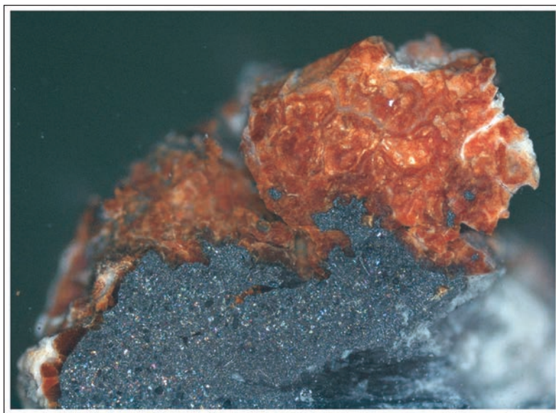
Obr. 10. Slitek olova – Pavlov. Oxidy olova (hnědé) vzniklé na základní hmotě olova prostoupené křemennými zrny (bílé). Optický mikroskop, odražené světlo, spodní okraj obrázku odpovídá 1,7 mm. Foto B. Šreinová.
