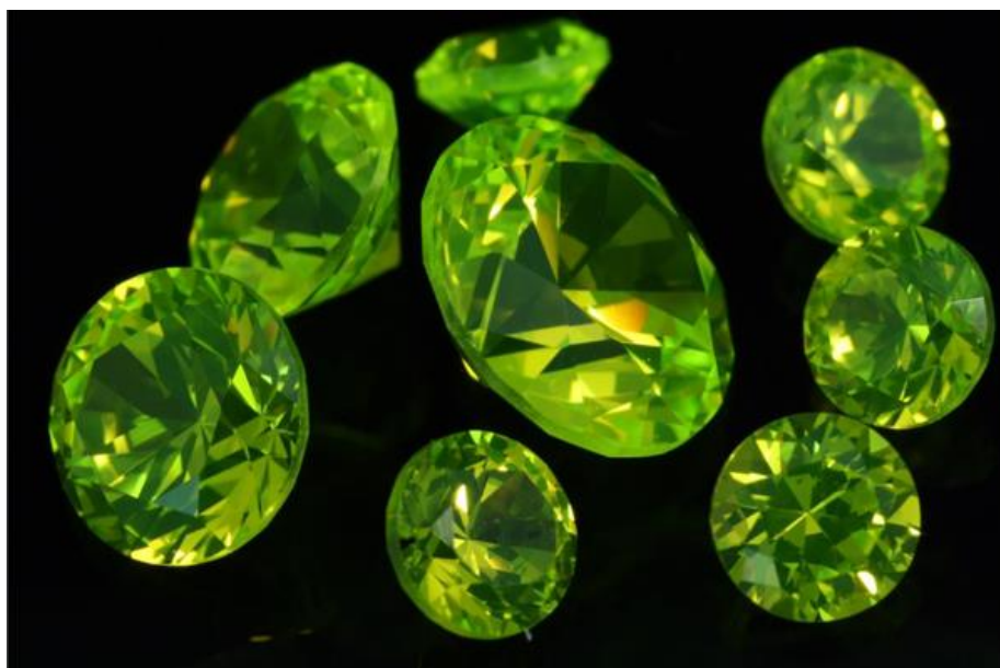
Aktivní šperkový kámen na bázi cerem dopovaného yttrito-hlinitého granátu Zdroj: FZÚ AV ČR, v. v. i.
