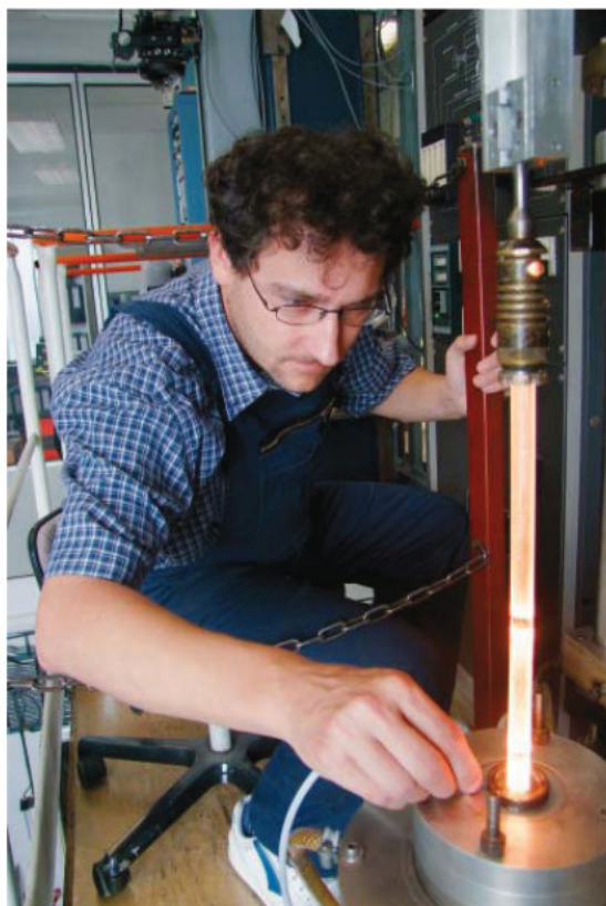
Obr. 7 Preforma optického vlákna zasunutá do grafitové pece v nejhřejší části jedné ze dvou tažících věží pro přípravu experimentálních optických vláken v ÚFE.
