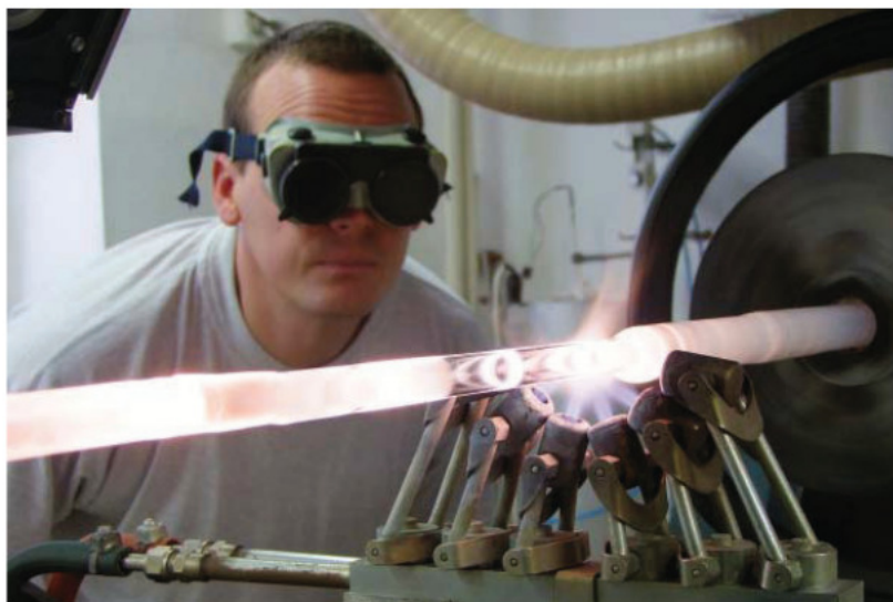
Obr. 10 Křemenná trubice při nanášení vrstev jádra pro dopování prvky vzácných zemin v ÚFE. Výsledná tyčka (preforma) se vytahuje do optického vlákna o průměru zlomku milimetru.
