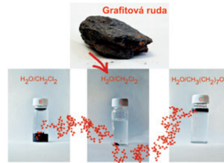
Schématické znázornění delaminačního procesu grafitové rudy a získané grafenové suspenze, A) před aplikací ultrazvuku, B) po aplikaci ultrazvuku v H 2 O/CH 2 Cl 2 systému, C) po aplikaci ultrazvuku v H 2 O/CH 3 (CH 2 ) 7 OH systému
