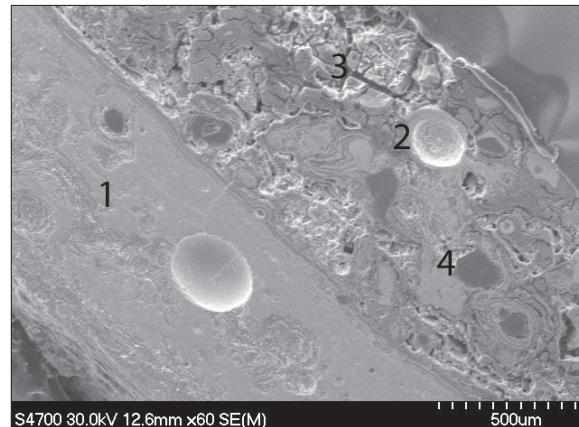
**Obr. 3/23:** Korálek 120-13. Přechod mezi žlutou výzdobou (1) a matricí korálku (2). Zřejmě jsou praskliny vzniklé v důsledku koroze (3) a zastoupení zrn křemene (4); měřeno SEM/EDS.
