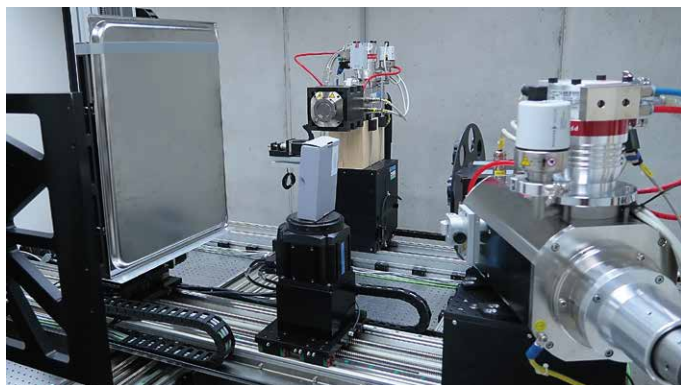
Obrázek 1: Umístění krabičky s proklínací tabulkou v tomografu TORATOM.
