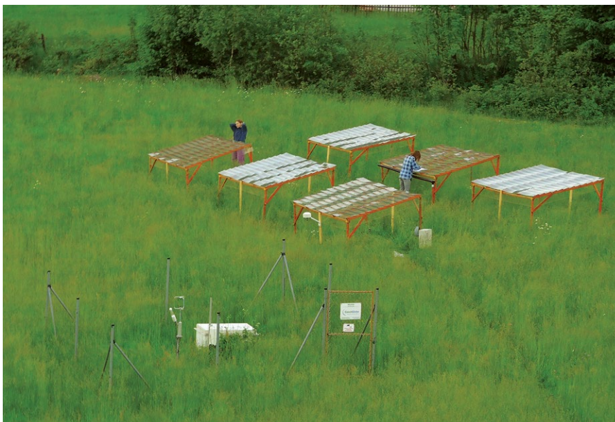
Měření vlivu sucha v otevřené krajině. „Střechy“ nepustí dešťovou vodu pod sebe, některé naopak částečně ano. Měří se rozdíl ve vegetaci pod nimi.
