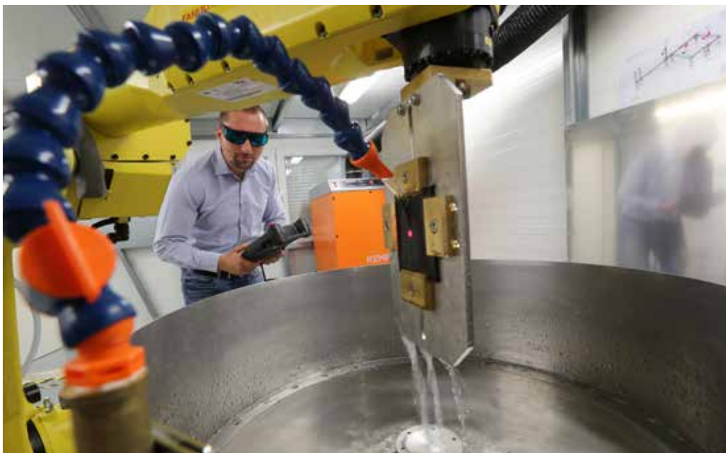
Lasery pro mikroobrábění, procesní stanice - Centrum HiLASE, Fyzikální ústav AV ČR
