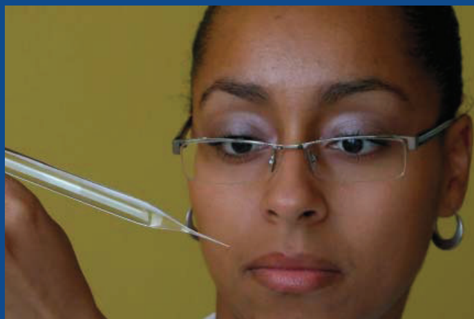
Obr. 8 Preforma přecházející do optického vlákna při tažení.
