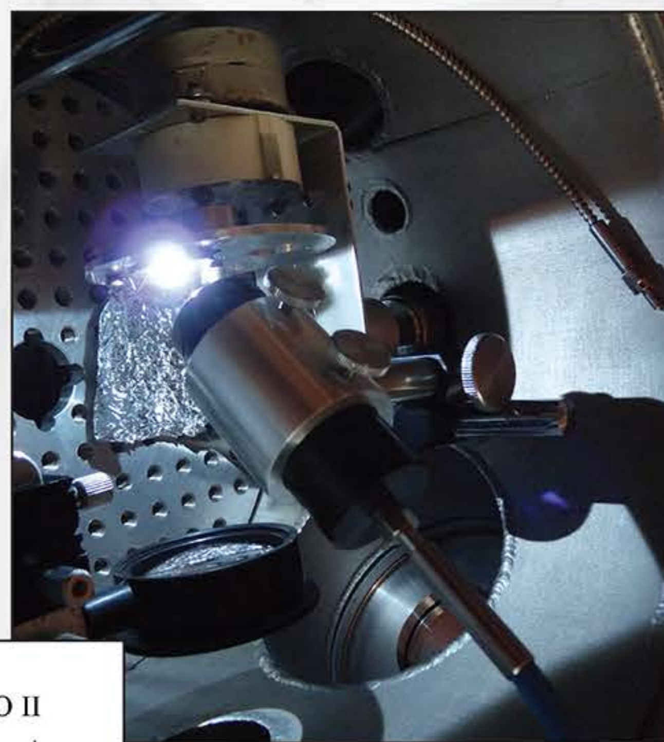
Ablací plazma meteoritu snímána objektivem kolimátoru, který je připojen k vysoce rozlišujícímu spektrografu echelle
