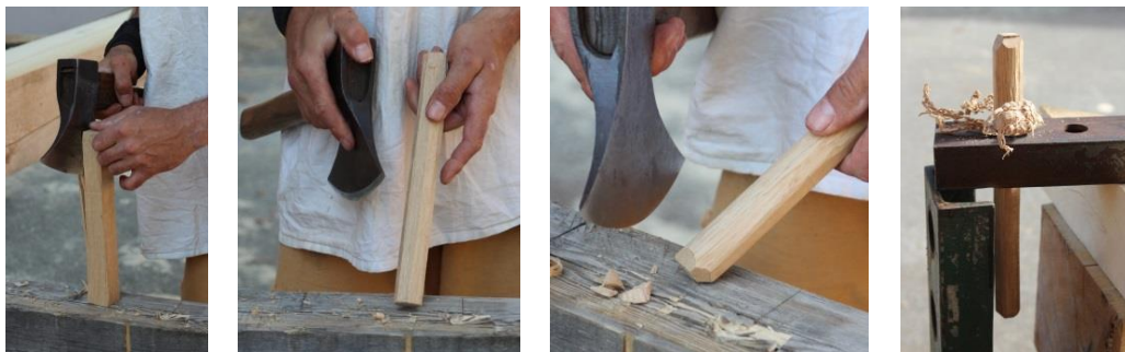
Obr. 15 Postup výroby kolíků
