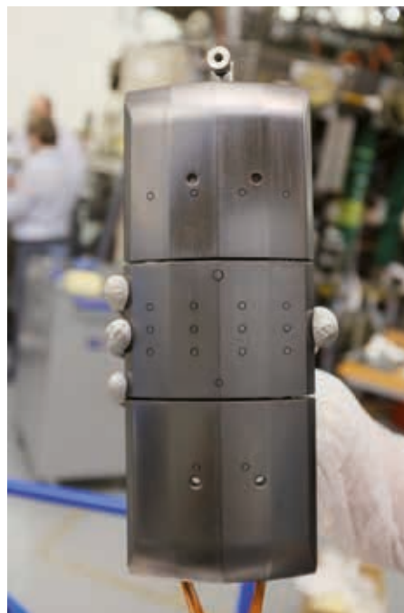
Testovací dlaždice první stěny tokamaku COMPASS pro studium toku energie a částic z plazmatu. Tested components of the tokamak COMPASS first wall for studying the flow of energy and particles in plasma.
