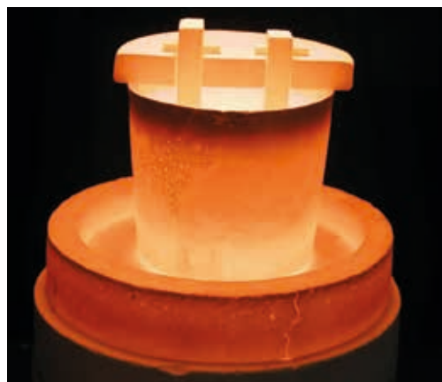
Koroze žáromateriálů taveninami skel. Crucible with refractory material corroded by glass melt.
