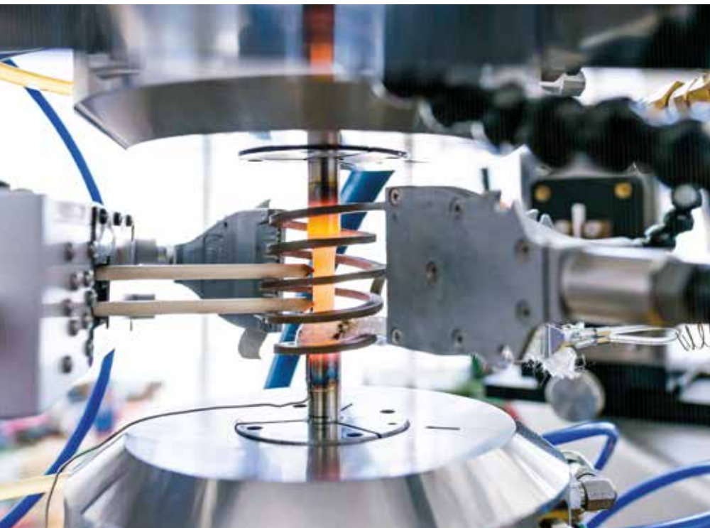
Experimentální uspořádání pro zkoušky termomechanické únavy superslitiny s termální bariérou. Střední část zkušebního vzorku (rozžhavená žlutooranžová oblast) upevněného v čelistech se indukčně ohřívá na teplotu 900 °C.
