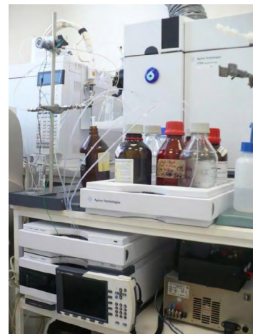
Obr. 5 HPLC-ICP-MS instrumentace pro speciální analýzu rtuti
