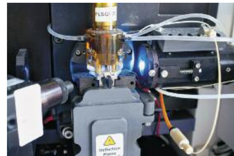
Obr. 2 Průtokový cytometr. Detail průtokové komůrky, ve které se mikroskopické částice pohybují za sebou v úzkém vodním proudu a interagují s paprskem laseru.
