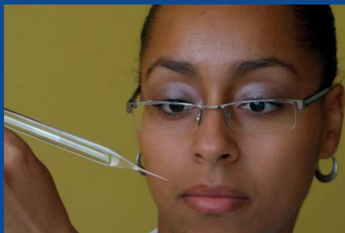
Obr. 8 Preforma přecházející do optického vlákna při tažení.
