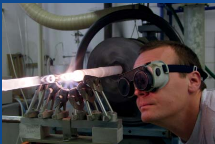
Obr. 7 Zařízení MCVD na přípravu preformem.
