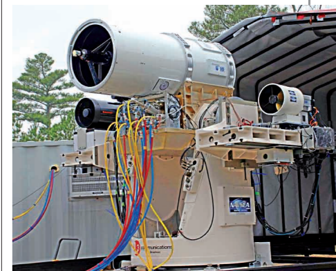
■ Obranný systém amerického námořnictva pro ničení taktických zbraní obsahuje 6 samostatných vláknových laserů, sloučených do jediného svazku
