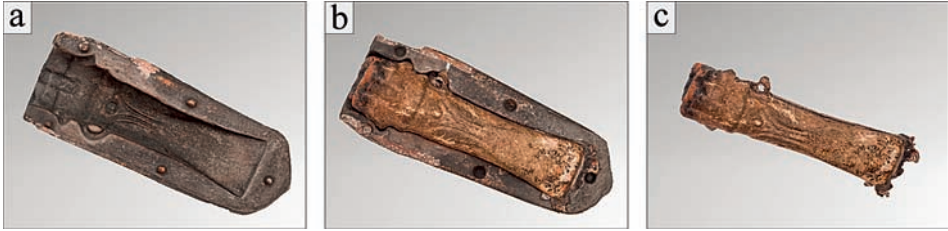
Fig. 12. The experimental Przedmieście type axe casting compatible with the casting mould from Elgiszewo. Obr. 12. Experimentální odlitek sekery typu Przedmieście odpovídající lici formě z Elgiszewa.
