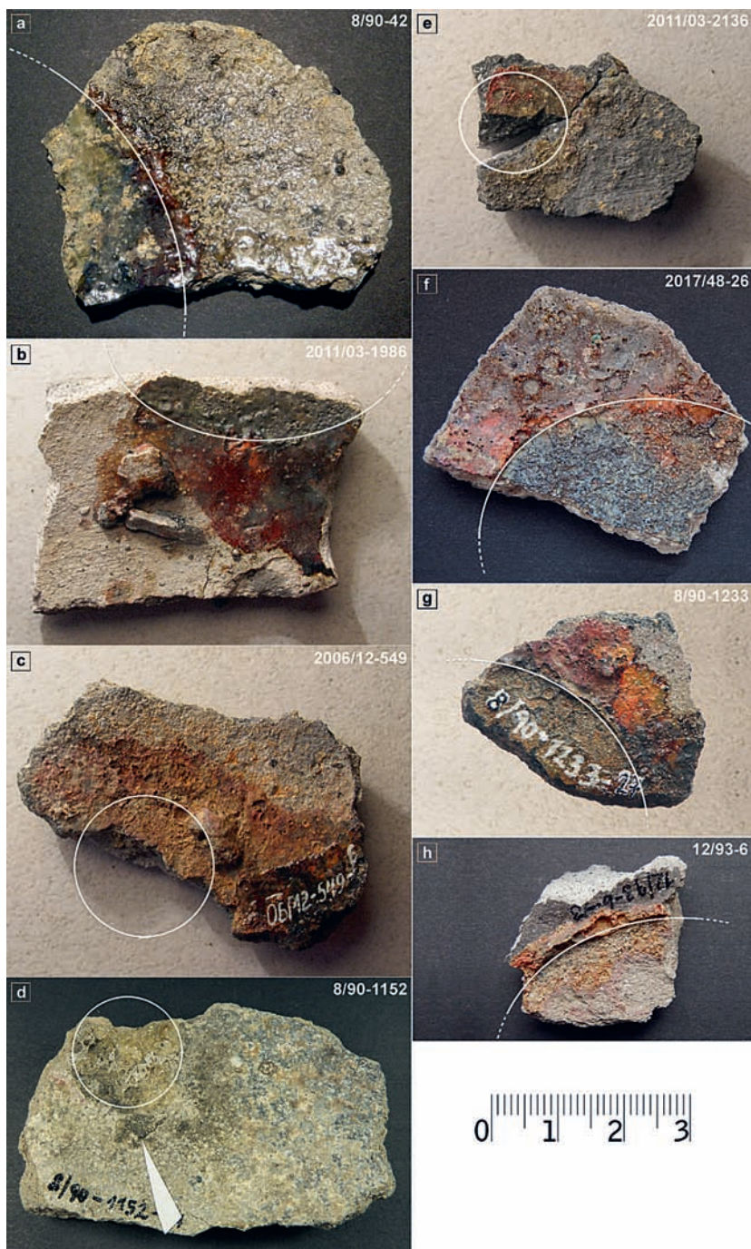
Obr. 24. Otisky po vytavených koláčích kovu na zlomcích metalurgických miskovitých střepech (dle návrhu autorů zpracovala S. Babušková).
