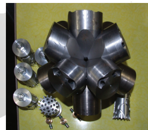
Magnetokumulativní implozivní generátor plazmatu pro přímou přeměnu kinetické energie plazmatu na elektrinu.
