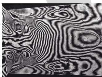
Interferogram proudění vzduchu v modelu parního ventilu.
