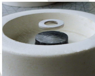
Model supravodivého ložiska setrvačnicku.
