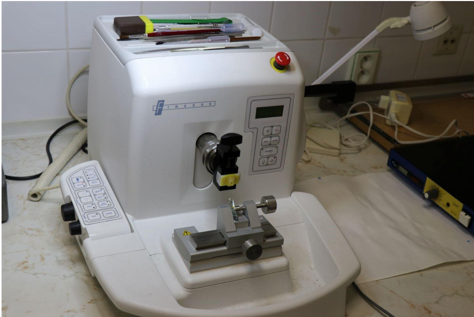
Na obrázku je přístroj mikrotom, který slouží k řezání vzorků na tenké řezy.
