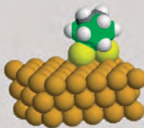
Model karboran-thiolové klastrové molekuly na zlatém povrchu s krystalografickou orientací (111)
