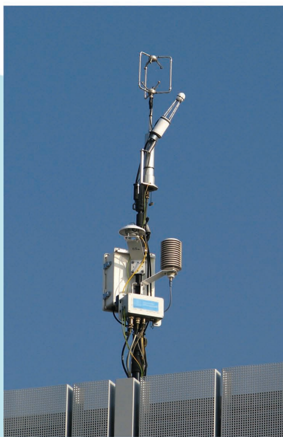
Detail měřicí stanice vybavené eddy kovariančním systémem pro sledování výměny CO 2 mezi urbánním ekosystémem a atmosférou. Stanice měří i další důležité parametry ovlivňující výměnu CO 2 (sluneční radiaci, teplotu a vlhkost vzduchu)
