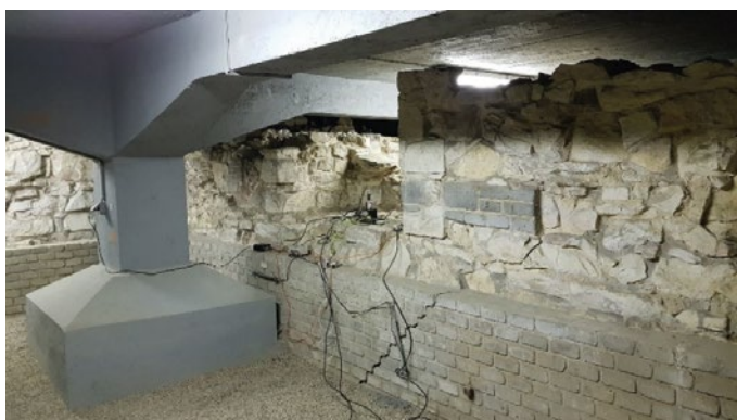
Obr. 2. Jeden z pěti vybraných bodů pro měření dynamické odezvy.
