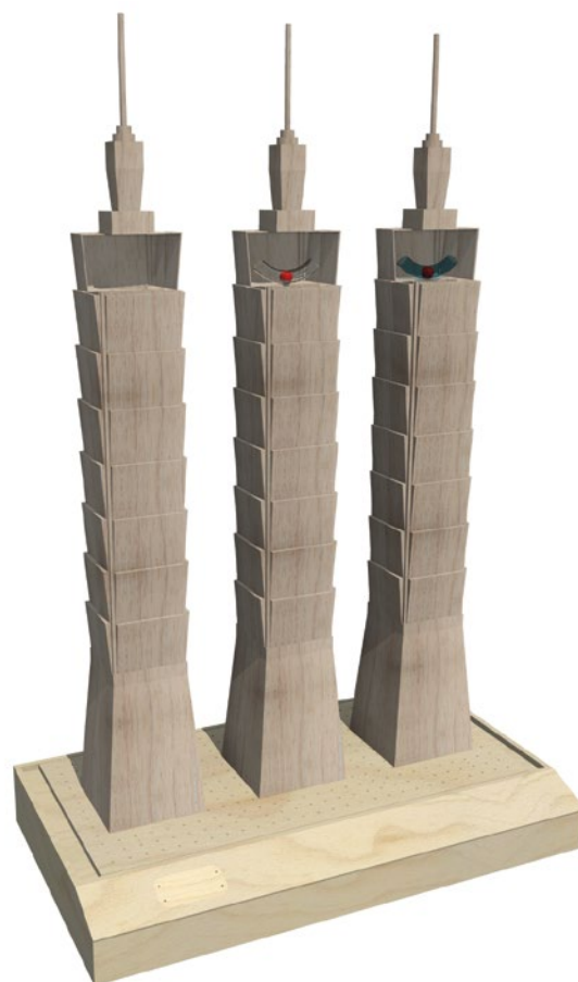
Obr. 2. Konstrukční návrh modelu tří budov mrakodrapu Tchaj-pej 101 bez pohlcovače a s pohlcovačem bez / s přidavným tlumením
