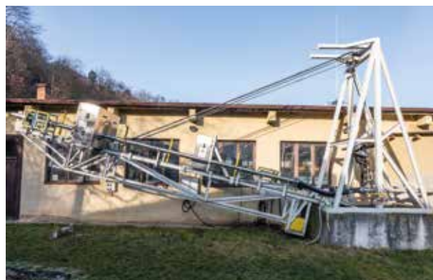
Venkovní experimentální trasa s trubkami ke sledování různých směsí pevných materiálů a nosných tekutin
