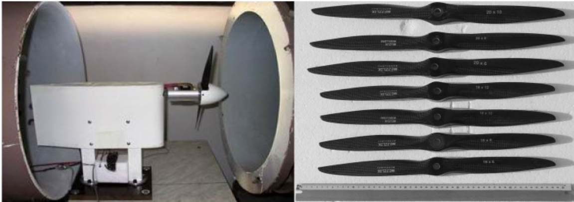
Obr. 1 Stend s vrtulí v měřicím prostoru AT, ukázka měřených vrtulí
