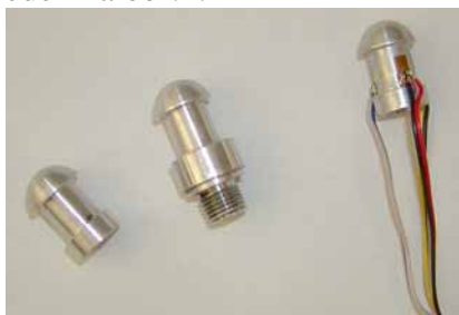
Obr. 1: Vyrobené prototypy senzoru kontaktní síly
