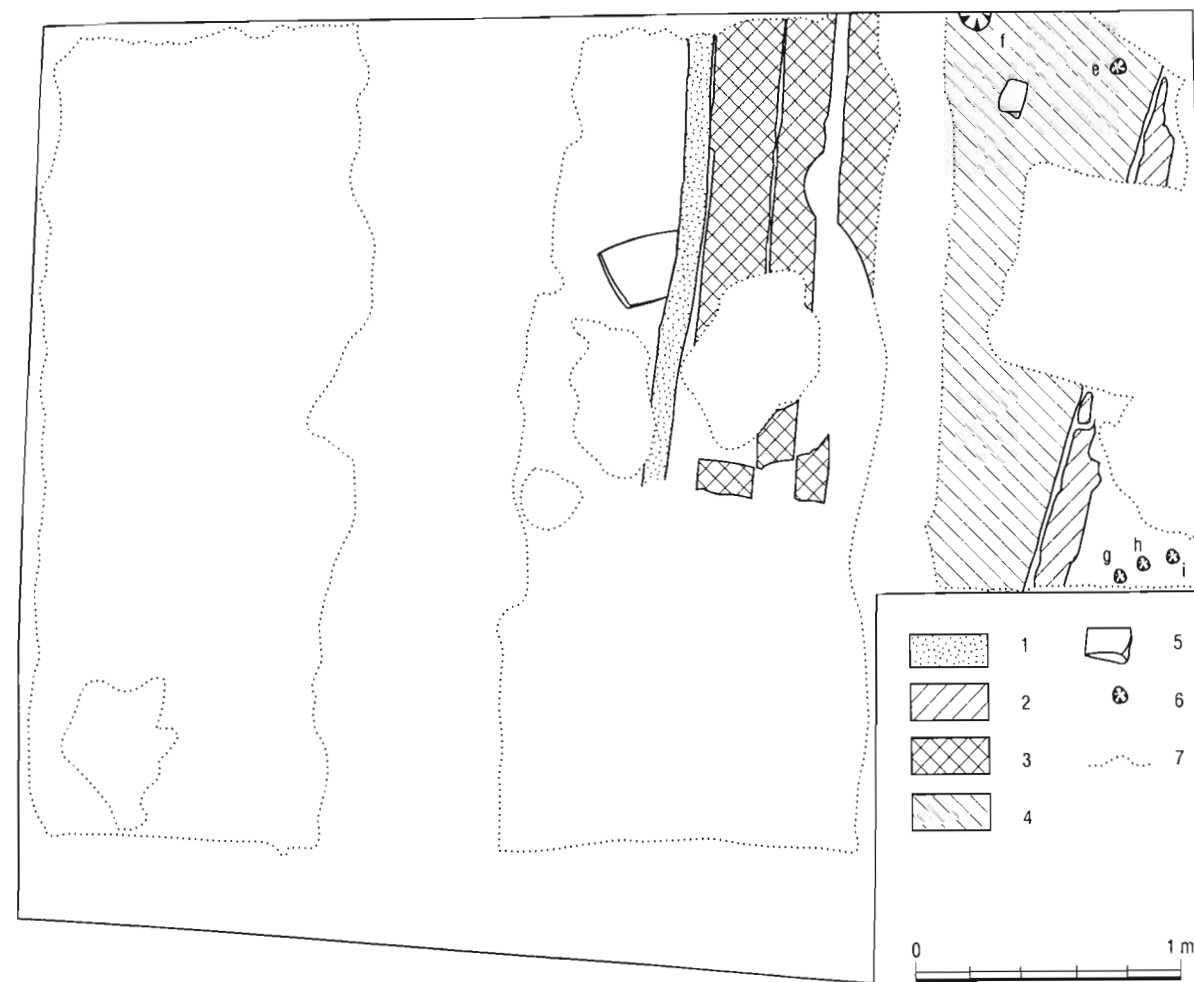
Obr. 11: Kanovnická čp. 73. Sonda 1, horizont 3 – půdorys. (1) trám obvodového věnce stavby, (2) mazanice, (3) zetlelé dřevo (prkna), (4) rozsah vrstvy 66, (5) opukové kameny, (6) kúlové jamky, (7) dochovaný rozsah horizontu.
