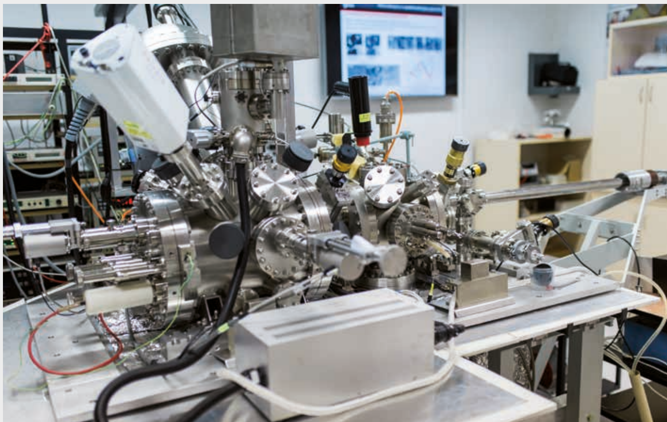
Chloubou Ústavu přístrojové techniky AV ČR je obří ultravysokovakuový rastrovací elektronový mikroskop, kterému se přezdívá „mamut“, a to nejen kvůli jeho velikosti, ale i proto, že dostal do výbavy speciální detektory a doplňky, čímž se stal unikátním na světě. Zařízení navrhli a z velké části sestavili právě zde.
