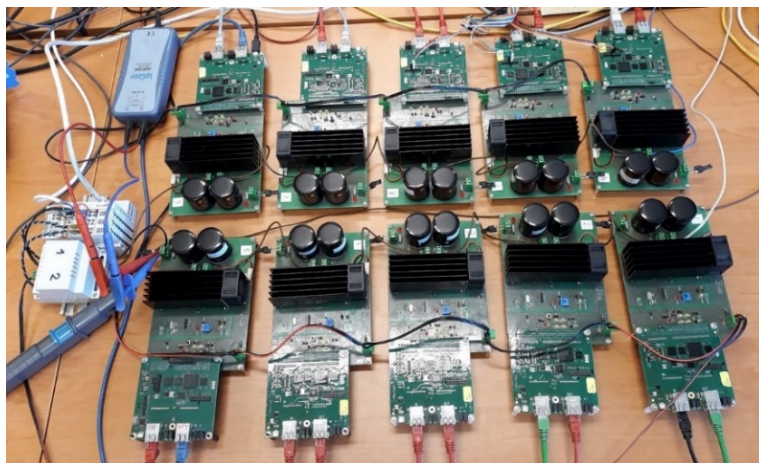
Obr. 20. Experimentální model měniče MMC (Modular Multilevel Converter)
