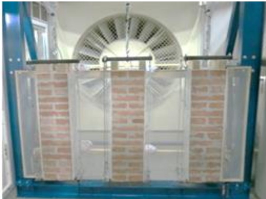
Testování segmentu cihelného zdiva v klimatické části aerodynamickém tunelu.
