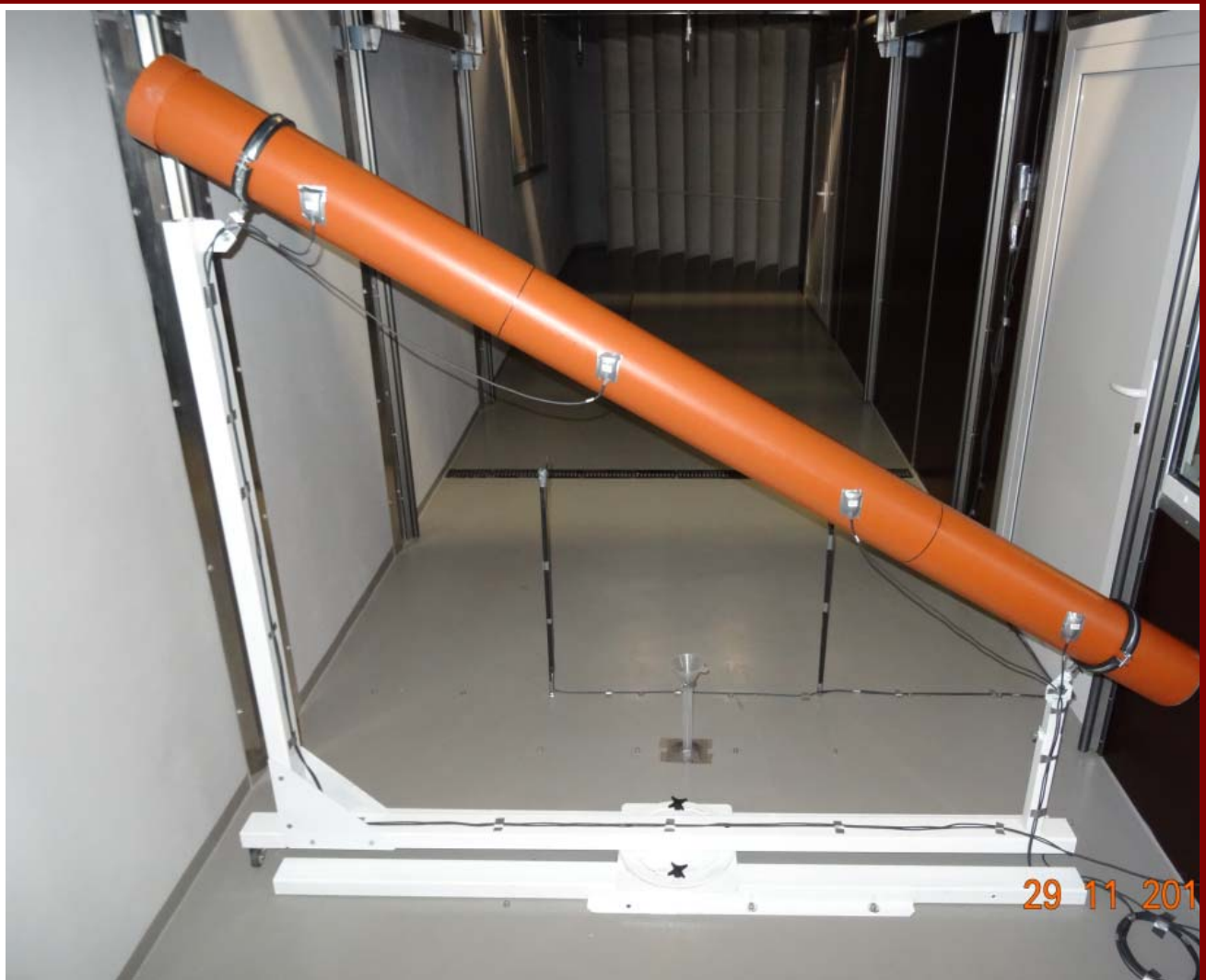
Úsekový model mostního závěsu v klimatické části tunelu před procesem tvorby námrazy.
