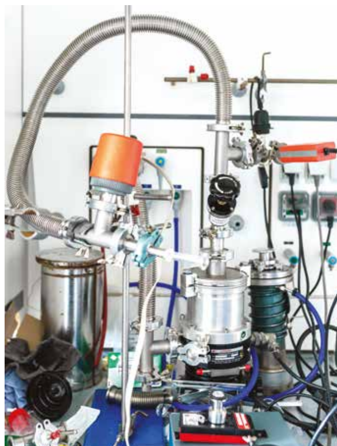
Část vakuové aparatury k pokusům s kapalným amoniakem a alkalickými kovy
