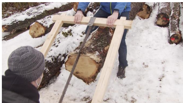
Foto vlevo: Takto se řezalo dřevo na rámy na římský způsob. (Foto: Gesa Prophet).
