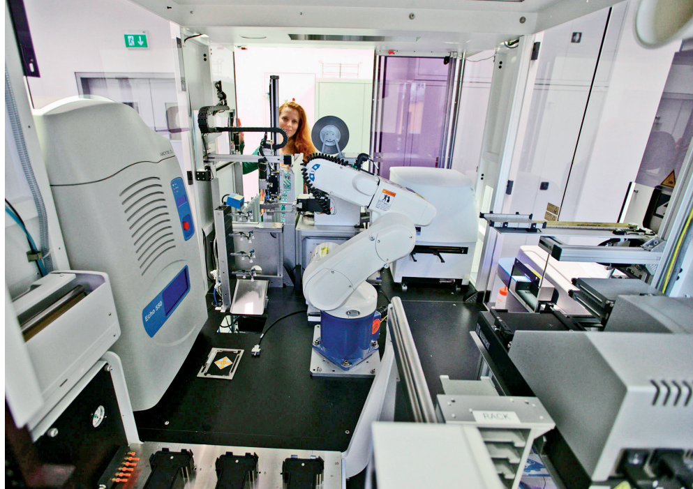
▲ AUTOMATICKÝ ROBOTICKÝ SYSTÉM s pohyblivým ramenem ve vysokokapacitní pipetovací stanici pro vyhledávání nových léčiv.
