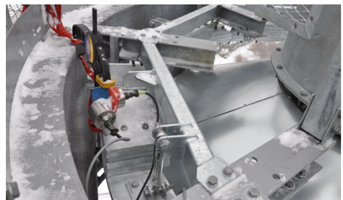
Fig. 3. A detail of the hinges and one pair of sensors. Photo: B. Přečová
