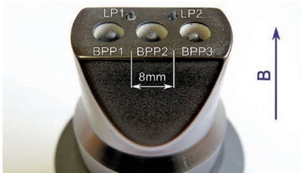
Obr. 22 Sondová hlavice se dvěma Langmuirovými sondami LP a trojicí Ball-pen sond BPP [3]
