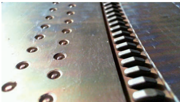
Obr. 27 Detail sondového pole: Ball-pen sondy (vlevo), Langmuirovy sondy (vpravo) [3]
