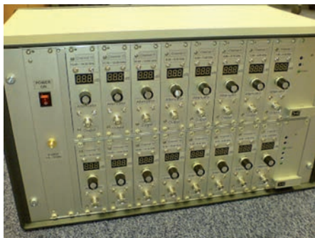
Obr. 21 Šestnáctikanálový přijímač radiometru (vlevo) a anténa radiometru před oknem do tokamaku (vpravo) [3]
