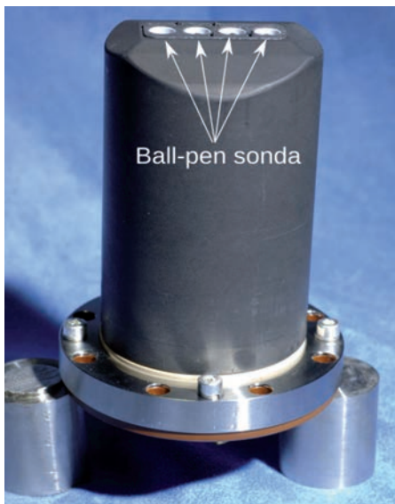
Obr. 23 Příklady sondových hlavice tokamaků ASDEX-U (vlevo) a MAST (vpravo) obsahujících Ball-pen sondy [3]
