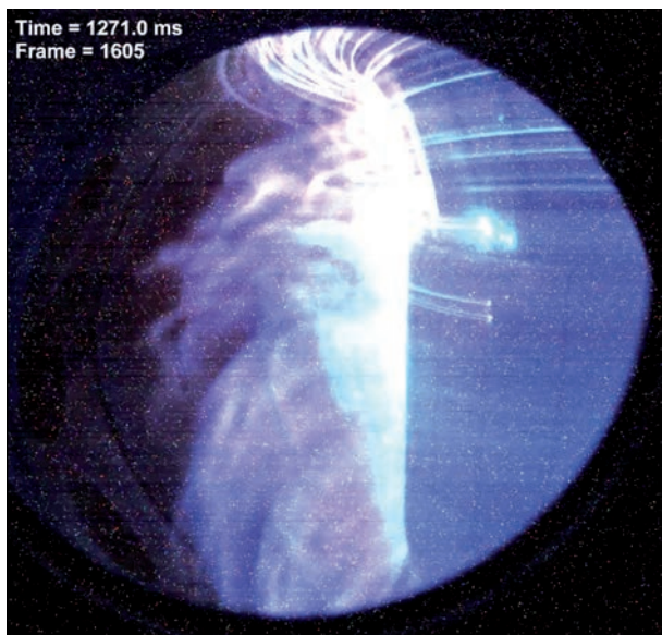
Obr. 56 Terminace svazku RE na vnitřní stěně v horní části tokamaku: světlo pochází z rekombinace iontů argonu a deuteria, výrazné filamenty RE sledují siločáry toroidálního magnetického pole, dokud nedojde k dopadu RE na stěnu nádoby [3]
