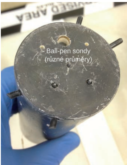
Obr. 23 Příklady sondových hlavice tokamaků ASDEX-U (vlevo) a MAST (vpravo) obsahujících Ball-pen sondy [3]
