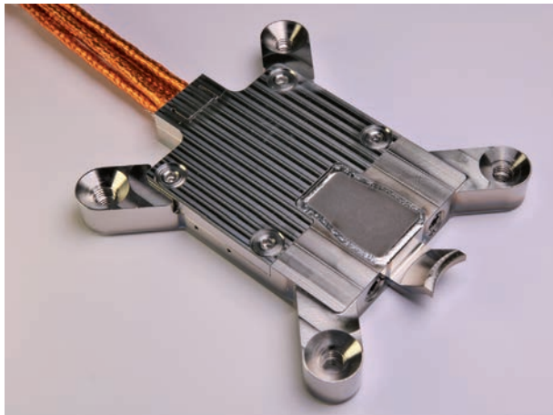
Obr. 69 Finální senzorová jednotka vyrobená pro ITER s indiovou kapslí ve střední části jednotky umožňující pravidelnou recalibraci integrovaného termočlánku pro měření teploty sensorů [3]
