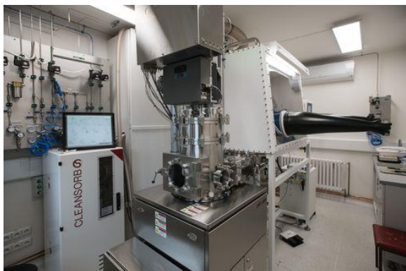
Aparatura pro ALD technologii nanášení atomárně tenkých vrstev Foto: Fyzikální ústav AV ČR
