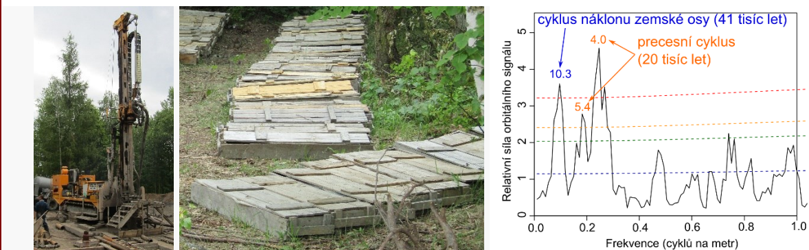
Vlevo: vrtná souprava; uprostřed: bedny s vrtným jádrem; vpravo: orbitální signál (klimatické cykly) v geochemickém záznamu z mostecké pánve.
