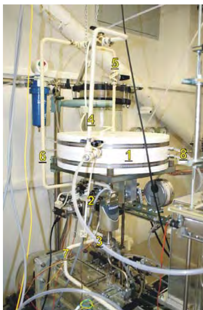
■ Obr. 6 Odparník molekulárního jódu v radiofrekvenční aparatuře, Ar výboj, komora-injektor
