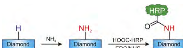
■ Obr. 12 Schematické zobrazení funkcionalizace povrchu nanokrystalické diamantové vrstvy amino skupinou a avidin-peroxidázou, tzv. karbodiimidovou metodou
