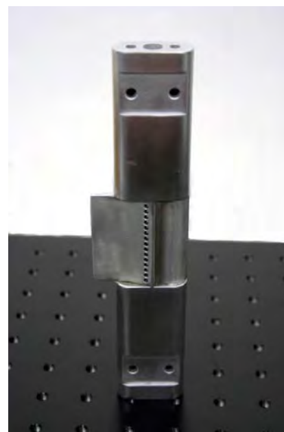
■ Obr. 6 Odparník molekulárního jódu v radiofrekvenční aparatuře, Ar výboj, komora-injektor
