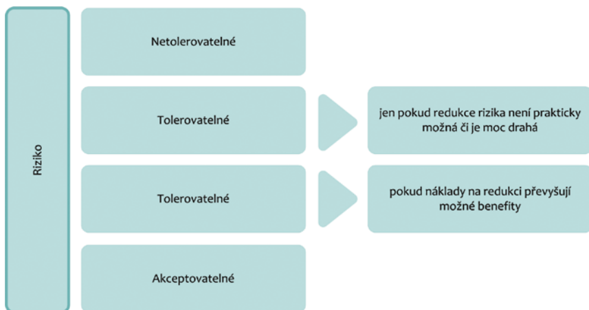
Obr. 8 Schéma úrovní rizik dle metody ALARP 23
