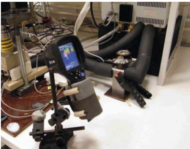
■ Obr. 10 Automatizovaná charakterizační aparatura pro testování termoelektrických modulů a materiálů.
