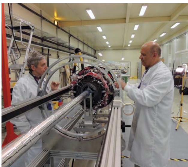
Obr. 1 Inženýři Fyzikálního ústavu AVČR Petr Šicho a Michal Tomášek při práci na modernizaci pixelového dráhového detektoru v CERN.
