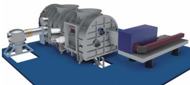
■ Obr. 3 3D model vakuového kompresoru petawattových laserových pulsů pro 10-Hz laserový systém L3-HAPLS Centra ELI-Beamlines.
