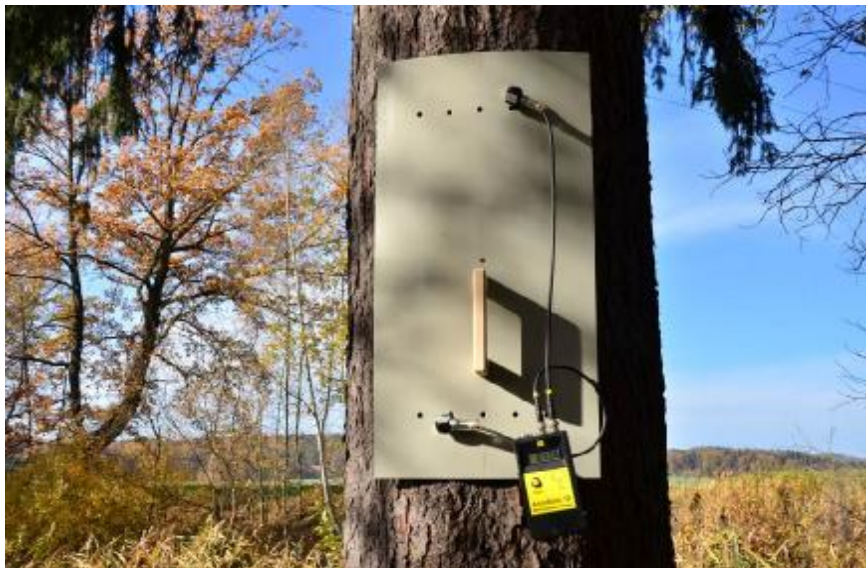
Šablona umožňující rozmístění senzorů při měření točitosti.
