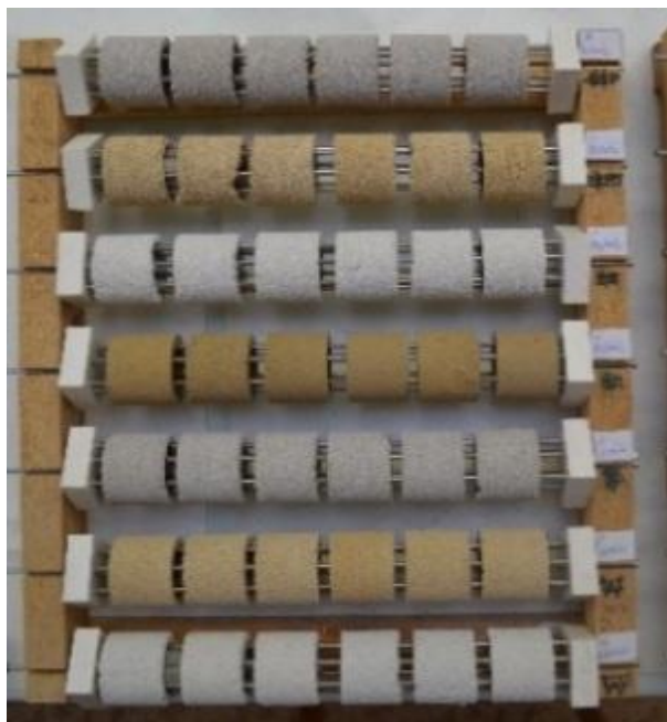
Vzorky malt ve tvaru trubek po ošetření konsolidantem před měřením pevnosti v tlaku.
