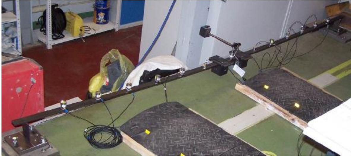
Fotografie experimentu ukazuje ocelový nosník se snímači zrychlení.
