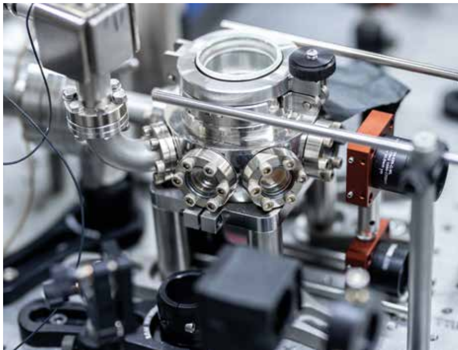
Zařízení, které vypadá spíše jako část nějaké miniaturní ponorky, je ve skutečnosti vakuová komůrka. Uvnitř se pomocí laserových svazků zachycují a chladí nanočástice.
