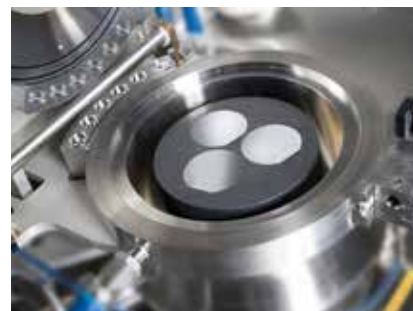
Otevřený výzkumný reaktor pro organokovovou epitaxi s připravenými epitaxními podložkami, v němž mohou růst nitridové nanoheterostrukтуры.
