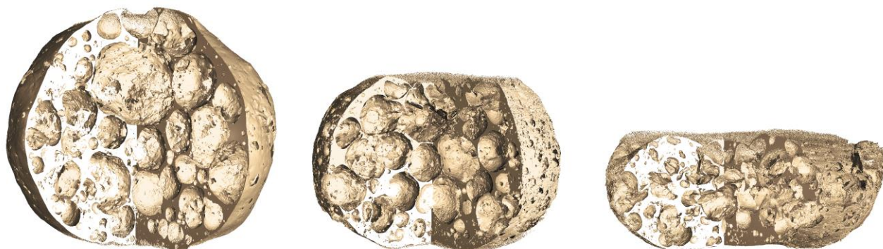
Vizualizace deformace vzorku APM pěny. Rekonstruované objemy deformující se struktury během tlakového experimentu při 0 %, 25 % a 50 % efektivní deformace v tlaku.
