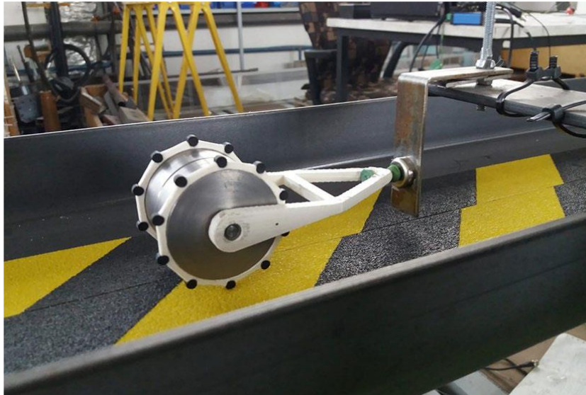
Model mostu: pohyblivé impulzní zatížení vyvozované valcím se polygonálním kolem.
